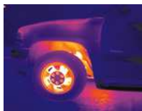
Inspection des freins
